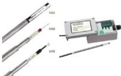
Le transmetteur de vitesse d'air 8455 TSI est conçu pour mesurer avec précision des vitesses d'air allant de 0.05 m/s à 50 m/s. Il utilise la technologie thermique dérivée des anémomètres à «fil chaud».
