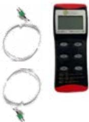
Deux entrées thermocouple k, et deux sondes modèle MGSV2000 fournies.
