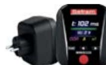
Mesureur de boucle de terre (en TT et TN), Test des DDR type A et AC, Vérification du câblage de la prise, Mesure de Tension TRMS,
