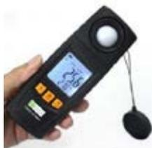
Le luxmètre numérique est spécialement conçu pour mesurer l'éclairement et luminance à des fins de détermination de l'intensité lumineuse, de contrôle de la qualité et protection de la santé dans divers environnements
