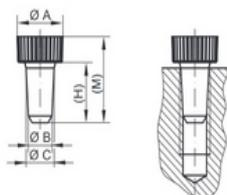
Bouchons autofiletés conique pour absorber des écarts de tolérances importants de 9 mm à 11 mm.
