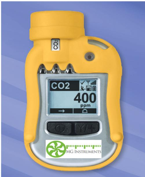
G02-0007-PRO-CO2 est le premier détecteur sans fil personnel de dioxyde de carbone au monde. Il fournit aux professionnels de la sécurité un accès à distance sans fil aux lectures des appareils en temps réel et au statut des alarmes pour une meilleure visibilité et une réponse plus rapide en cas d'incident.
