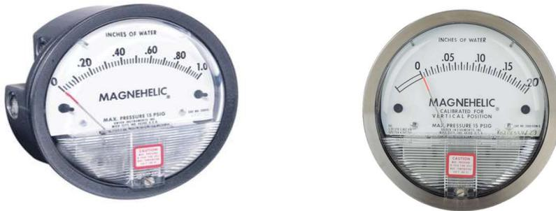
Le principe du Magnehelic®, mouvement sans friction, est la garantie permettant l'indication de basses pressions, dépressions, pressions différentielles d'air ou de gaz neutres non corrosifs. Résistant aux chocs, vibrations et surpressions, sans fluide manométrique, ni piles donc pas de problèmes de fuite, évaporation, gel, positionnement ou niveau.
