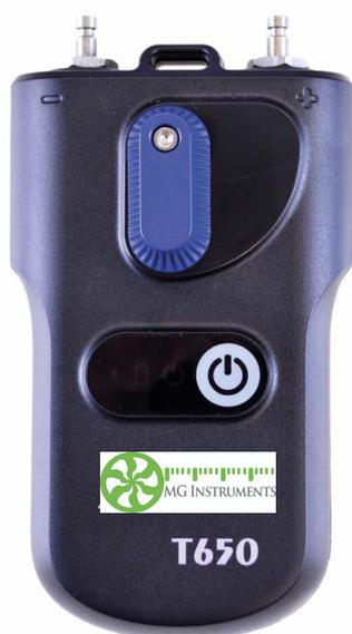
Cet appareil est conçu pour l'équilibrage hydraulique des systèmes de chauffage et de refroidissement. Il permet de mesurer la pression statique, les pressions différentielles et le débit dans lesdits systèmes.
