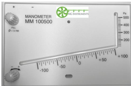
Ce manomètre à colonne de liquide est destinée à être utilisée dans les environnements pour l'air et les gaz non corrosifs. Il est conçu avec réservoir de surpression pour protéger le liquide du manomètre de fuir dans le conduit pendant une surpression. Il comprend un étalonnage du point zéro réglable sur site et autocollants de limite de pression. Cette série est disponible en option avec différent niveau de bulle
