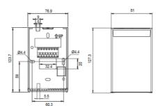
RMW82/83 HR+T et transmetteurs de mesure de température TMW82/83 uniquement pour un montage mural.
