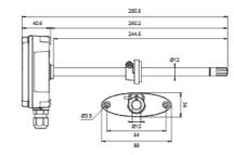
Transmetteurs séries RMD82/83 (D) et TMD82/83 pour la mesure de l' HR+T et de la température pour les conduites.
